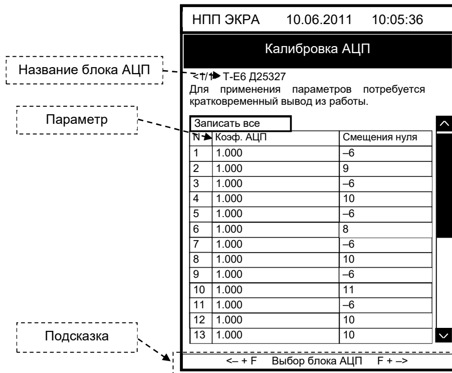
Рисунок 20 – Внешний вид меню Калибровка АЦП
